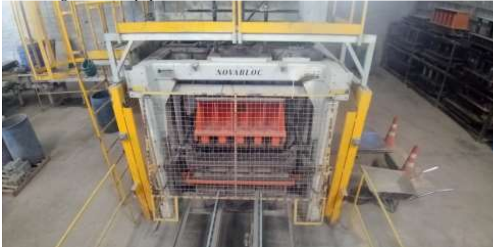
Figura 13 - Equipamento onde são moldados os blocos de concreto
